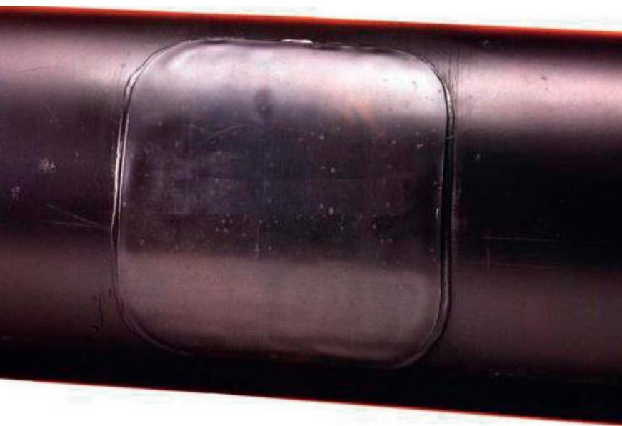
Термоплавкий наполнитель «НОВОРАД-ТЗ» - это специальная клеевая композиция. При расплавлении обладает свойством высокой текучести, благодаря чему заполняет все неровности рельефа поверхности и обеспечивает высокую адгезию к стальной поверхности, полиэтилену и ремонтному материалу «НОВОРАД-Р». Поставляется в виде рулонной ленты или в виде прутка.
