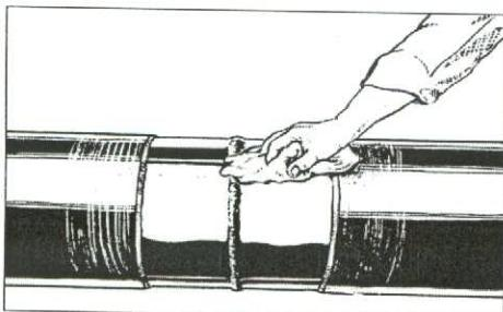
Рисунок 5 – Удаление пыли и абразивных частиц
