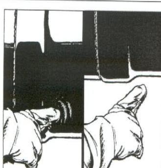
Рисунок 19 – Проверка степени размягчения адгезива
