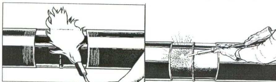
Рисунок 3 – Сушка трубы перед абразивной очисткой
