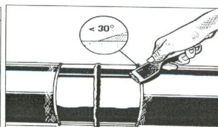
Рисунок 2 – Создание скоса кромок заводского покрытия
