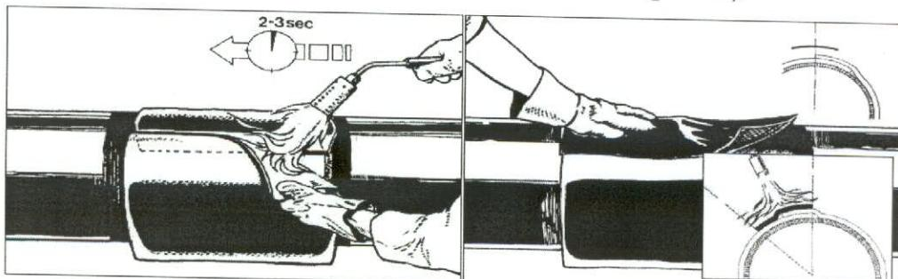
Рисунок 12 – Прогрев замковой пластины
