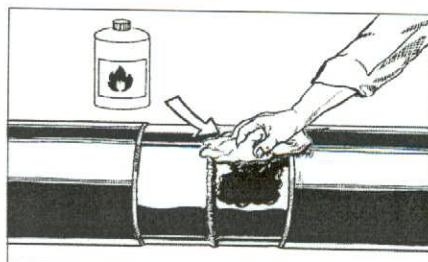
Рисунок 1 – Удаление масляных пятен с трубы и заводского покрытия
